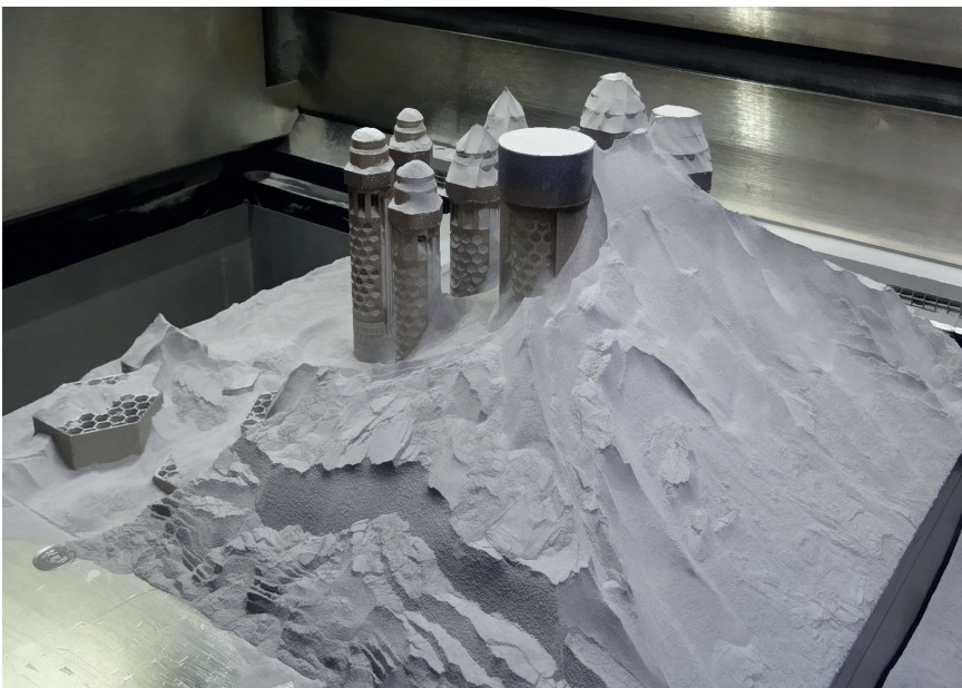
In rund 24 Stunden ist ein Baujob mit bis zu 30 Düsen in der SLM-Maschine abgearbeitet. © Witosa
